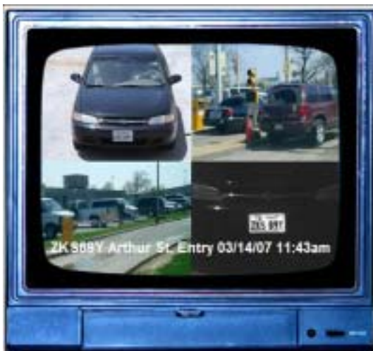
典型之搜尋結果，系統顯示車牌影像及相關訊息資料字幕
